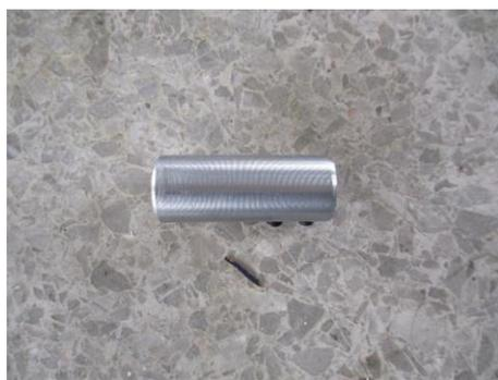
接続する土台とモーターの径が違うため、ジョイントの内径を旋盤で削ることに苦労した。
