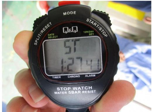
先ほどのキャップの着火速度を計測しました。600ワットのニクロム線を使って、100V、120V、130V、時の着火速度を計測しました。100Vでは約2分30秒、120Vでは約2分、130Vで約1分30秒で着火します。電流が大きいため、電源の取り方が次の課題となります。
