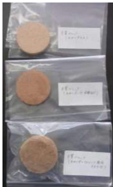
図8. 試作した3種類の木質ペレット
