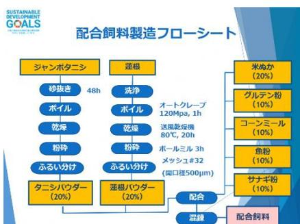
図 3. 配合飼料製造フロー
