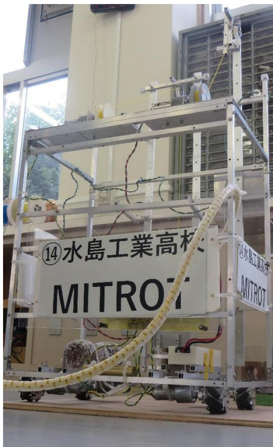
図4 ロボットのフレーム
