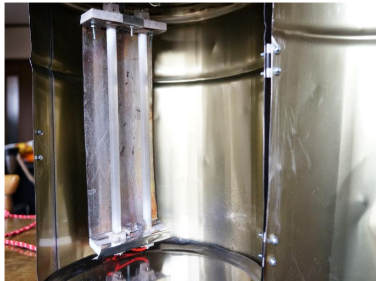
図 8 ヒーターの取り付け
