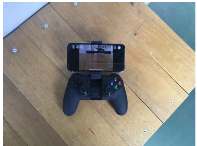
図4 ドローンを操作するコントローラー(コントローラーの上の部分に専用のアプリを入れたスマートフォンをセットしてドローンを操作する。)
