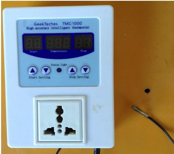
図4 温度制御装置
