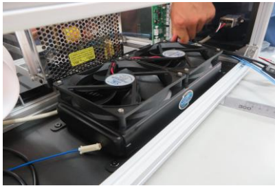
(図 4) 水冷ファンを取り付けている様子
