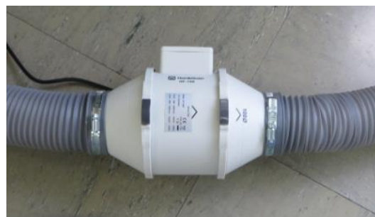
(図 9) 排気ファンにダクトを取り付けた
