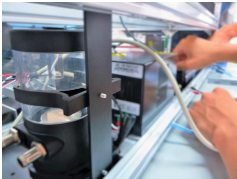
(図 5) 水冷装置のタンクの取り付け
