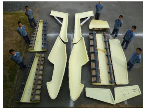
写真16 完成した11個のメス型
