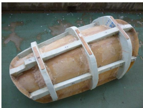
写真15 メス型に補強材を付けた状態
