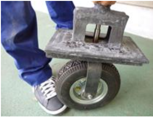
写真 25 タイヤ固定部も炭素繊維製
