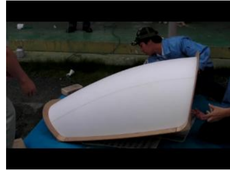
写真10 風防のスチロール原型
