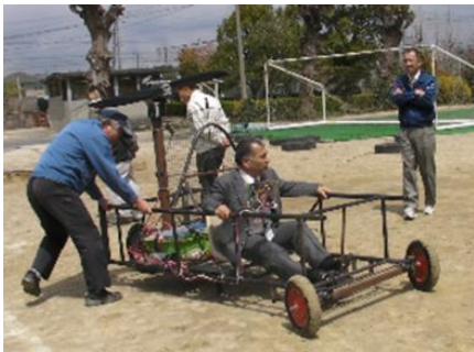
写真 27 3輪車による動力試験
