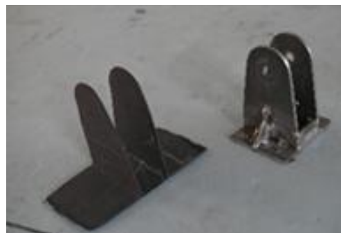
写真 23 右はジュラルミン製部品 左は炭素繊維製
