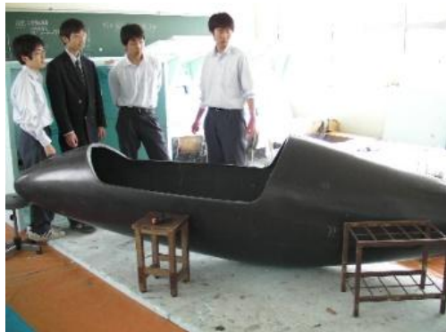
写真 20 完成した炭素繊維製機体（胴体部）
