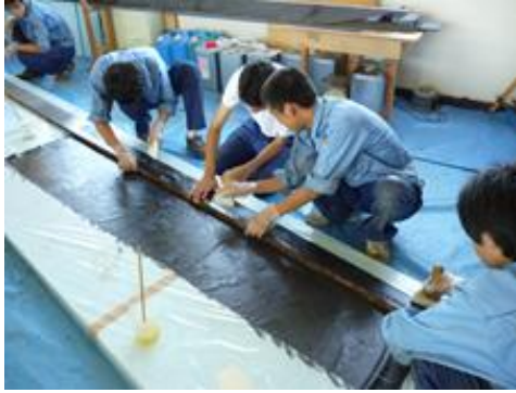
写真7 カーボンハニカム複合材に炭素繊維を巻き付け中
