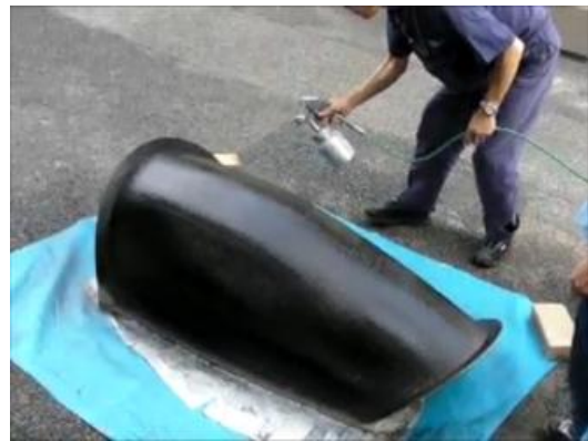
写真11 スチロール原型に樹脂を塗布中
