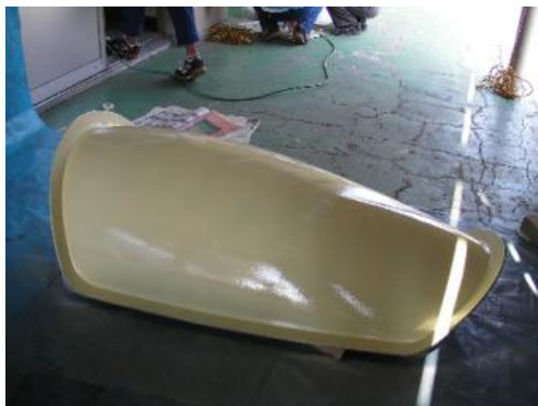
写真13 ゲルコートを塗布した状態
