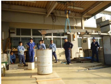
写真8 主翼桁の荷重試験
