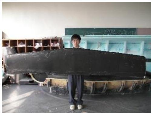
写真 21 完成した炭素繊維製機体（水平尾翼部）
