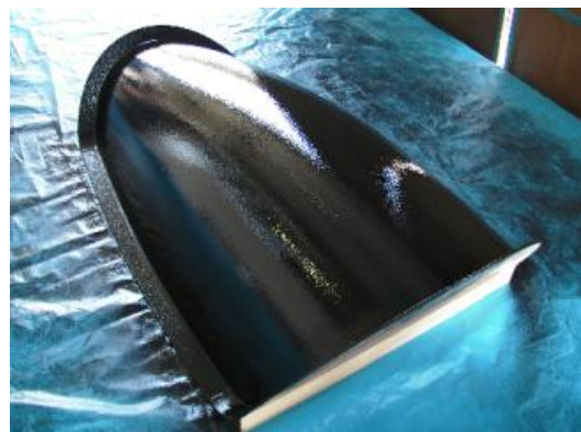
写真12 樹脂の塗布を3回行った状態
