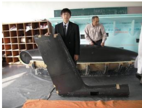
写真 22 完成した炭素繊維製機体（垂直尾翼部）
