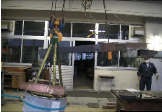
桁の強度試験
