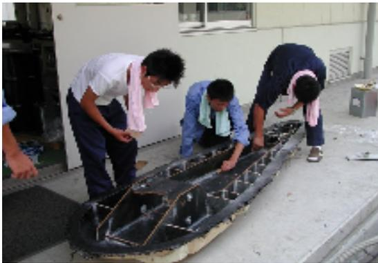
カーボンハニカムにより「ウルトラMECIA」のモノコックボディを製作しているところ
