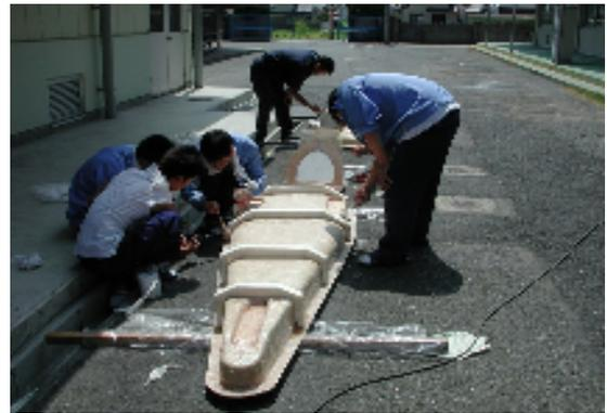
スチロール型から「ウルトラMECIA」のメス型を製作しているところ
