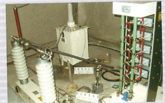
パソコンを用いた高電圧実験装置
