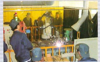
溶接ロボット
